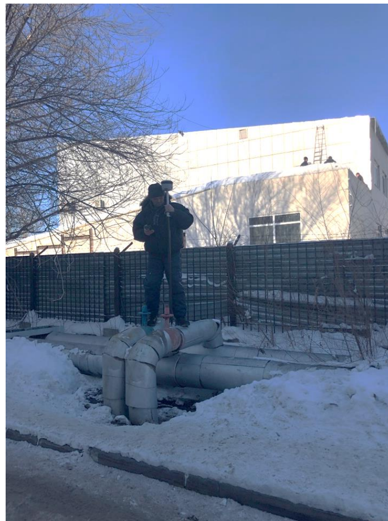
Координирование места измерения температуры при помощи геодезического приемника
