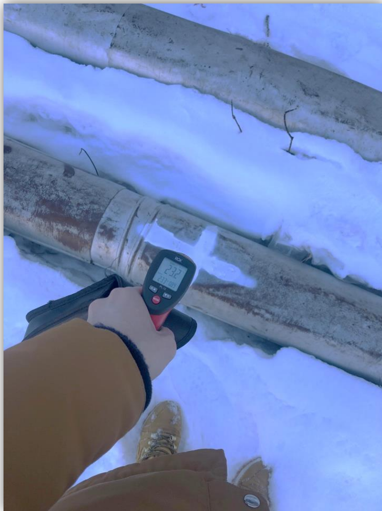
Измерение температуры пирометром
